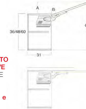
SCHEMA MONTAGGIO LIMITATORE PER RIBALTA H 36 FLAP DOOR LIMITER INSTALLATION DIAGRAM H 36
